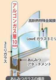
**断熱** 熱を伝えにくいアルゴンガスとLow-Eガラスで断熱性能は1枚ガラスの約**4倍**! (日本板硝子(株)算出数値)
